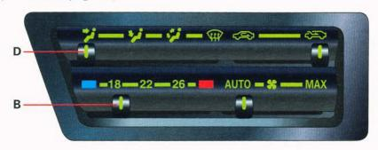
La température peut être modulée par la commande **B.** A gauche ; le plus froid, à droite ; le plus chaud.
