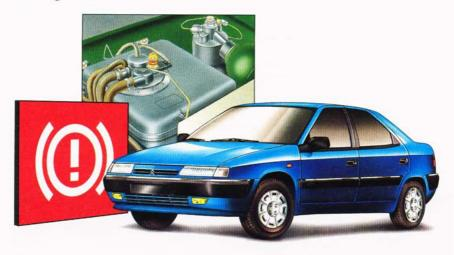
Système ABS - ce système augmente la sécurité en empéchant le blocage des roues en cas de freinage brutal ou dans des conditions d'adhérence faible.
