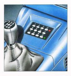
Ce dispositif antivol permet le verrouillage du système de contrôle moteur. à partir qu'un code confidentiel à quatre chiffres reprogrammable.
