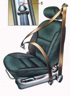
choc. Vérifiez régulièrement le bon état des sangles, des attaches de ceintures et de leur point d'ancrage, particulièrement après un choc (en cas de remplacement utilisez des pièces de référence identique. Ne modifiez pas le montage).
