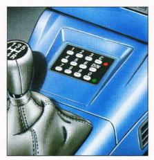
Ce dispositif antivol permet le verrouillage de l'injection électronique après avoir programmé un code confidentiel de quatre chiffres.
